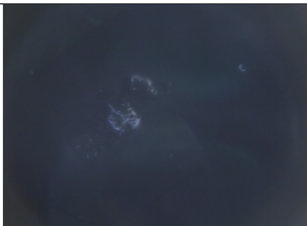
Figura 8. Imagem obtida em Luz Incidente e Campo Escuro com ampliação de 50x, após a fusão do Ácido Benzóico no Hot Stage (122,5°C).
